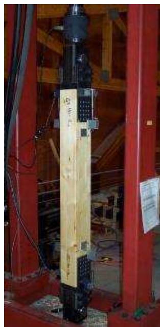
图 22. 带铆接连接的胶合木支撑测试
