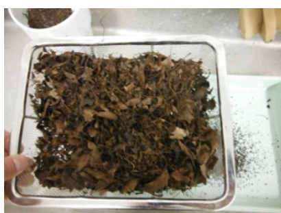
写真 3.1 4mm 以上粒径を除去
