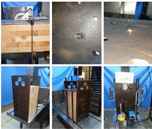
图 2 剪切试件制作过程
