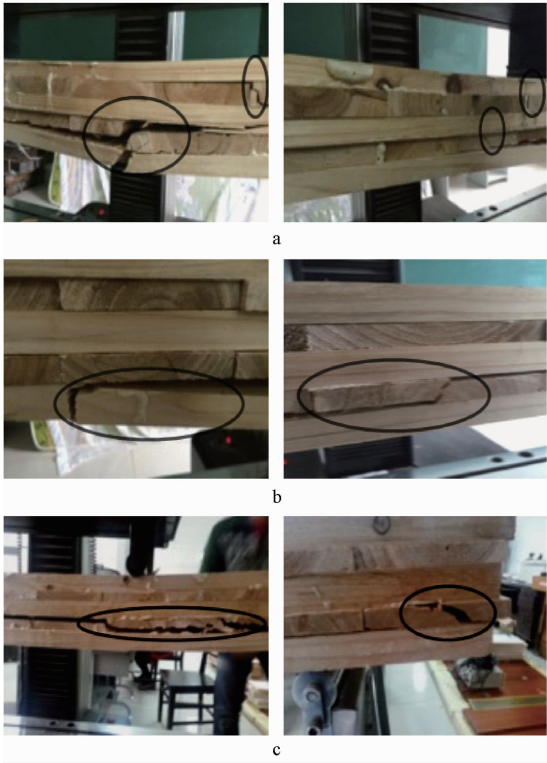
图 8 奇、偶层厚比例不同的破坏模式
