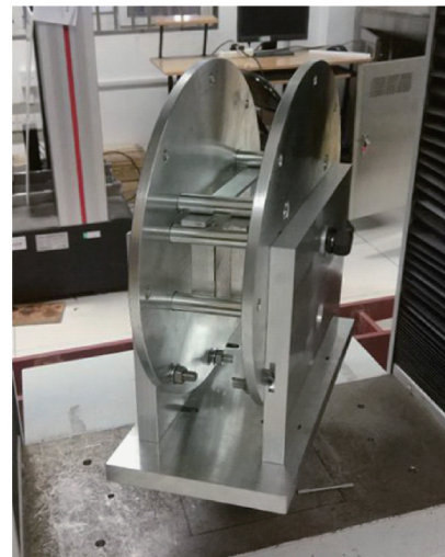
图4 多角度握钉力试验夹持装置示意(左)与实物(右)
